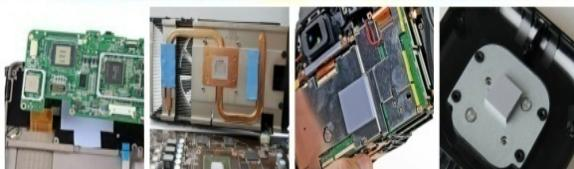
**TIF™ 700** 系列热传导界面材料是填充发热器件和散热片或金属底座二者之间的空气间隙。它们的柔性、弹性特征使其能够用于覆盖非常不平整的表面。
