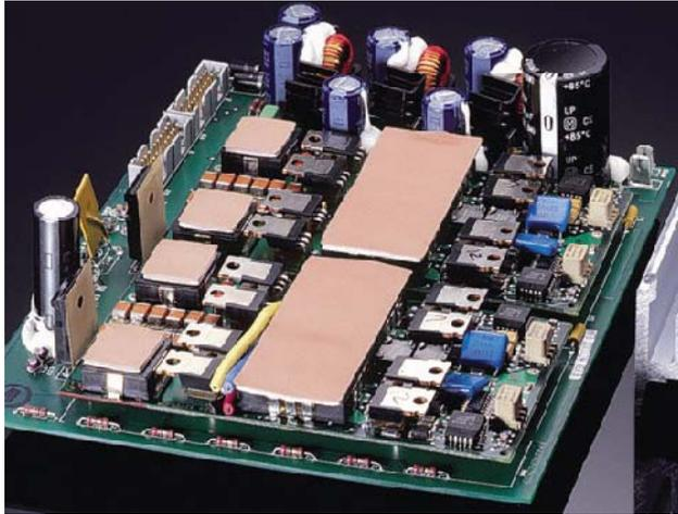
TIF™200-01U 系列热传导界面材料是填充发热器件和散热片或金属底座二者之间的空气间隙。它们的柔性、弹性特征使其能够用于覆盖非常不平整的表面。
