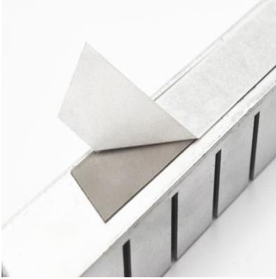
TIC® 800H 系列是一种高性能、高性价比的导热界面材料，具备独特的晶粒定向结构，能够精确贴合器件表面，有效放大热传导路径与转换效率。在超过其相变温度50°C时，材料开始软化并发生相变，能够充分填充器件之间微小且不规则的接触缝隙，形成低热阻的界面，显著提升散热性能。
