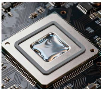
**TIC®800M** 是由多种金属混合制成的新型相变化导热产品，专为解决散热难题与提升应用可靠性设计。该材料兼具高导热性能，且不易蒸发、安全无毒、物化性质稳定。当温度高于其相变温度时，材料会软化并发生相变，能够紧密填充器件表面微小的不规则接触面，形成低接触热阻的导热界面，从而实现优异的散热效果。
